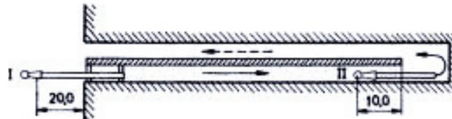
Сл. 273: Сепаратно проветрување при изработка на поткоп
