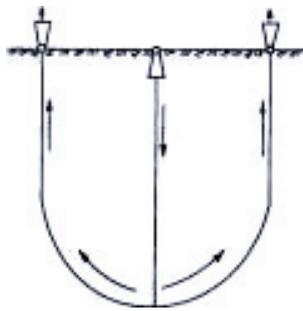
Во пракса се случува да работат комбинирано три или повеќе вентилатори, притоа некои од нив се поврзани паралелно а некои сериски. На сл. 268 е прикажана сериска работа на три вентилатори од кои два работа депресивно, а еден компресивно.
